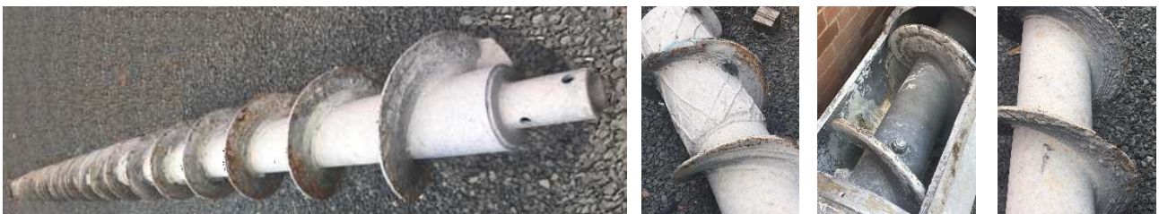
Fotos da Rosca Transportadora desgastada
